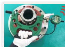
快速卡规2186-125/275 (用于测量 \varnothing 105n6+0.045/+0.023 / \varnothing 270h7 0/-0.052 )
