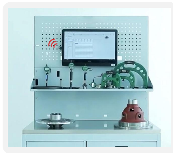
快速卡规2186-125/275 (用于测量 \varnothing 105n6+0.045/+0.023 / \varnothing 270h7 0/-0.052 )
